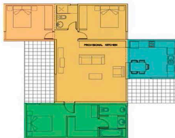
MODULE 1 49,00m 2 SALON+CHAMBRE+SALLE DE BAIN MODULE 2 13,00m 2 CUISINE MODULE 3 12,80m 2 CHAMBRE 2 MODULE 4 25,00m 2 CHAMBRE PRINCIPALE+SALLE DE BAIN+DRESSING
